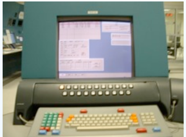
Particolare dello schermo dati e tastiere del "Pilota". La stazione del pilota è usata per simulare la navigazione e le manovre degli aerei virtuali, sia in volo sia a terra negli aeroporti, usando "tasti" (quelli colorati) disegnati specificamente per facilitare l'entrata dei dati in specifiche caselle.
