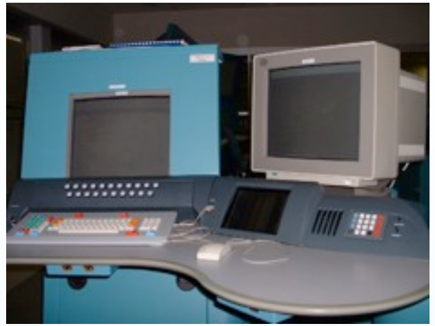
Nuova Stazione del "Pilota"; lo schermo dati a sinistra e schermo geografico a destra.
